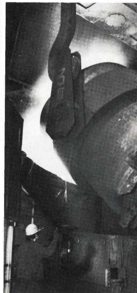
Chargieren von Roh Eisen in einen 140-Tonnen-LD-Tiegel im LD-Stahlwerk III. Foto: VOEST-Alpine AG
